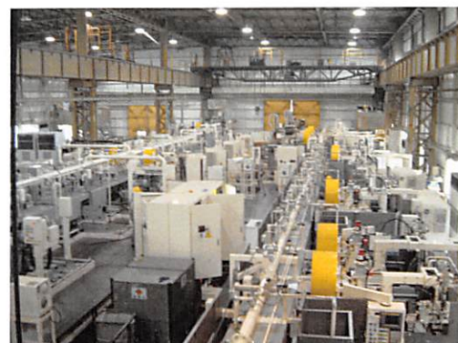
【フレキシブルトランスファライン】 （自動車部品加工ライン）
