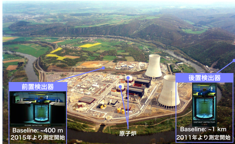
図1 Double Chooz実験の原子炉と両検出器の位置関係
