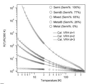
図 2: 様々な金属型・半導体型配合比の SWCNT ネットワークにおける電気伝導特性。
