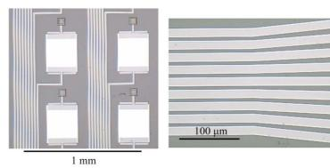
図 2: DIOS 衛星用に開発した省スペースの積層配線の (左) ピクセル部分および (右) 配線部分。 $<1~\mu m$  精度で Nb の上配線 (100~nm) と Al の下配線 (厚み~100~nm) が  $SiO_2$  絶縁膜を介して重なっている。
