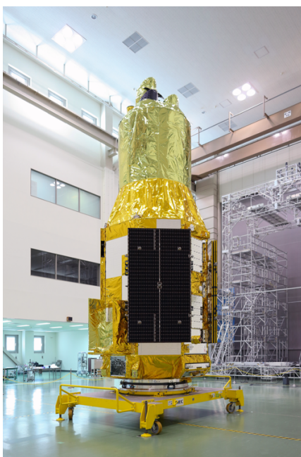
図 1: (左図) JAXA で公開された ASTRO-H 衛星。観測時の全長は約 14 m、重量は約 2700 kg。
