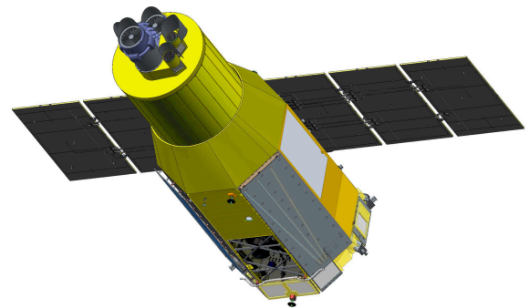
図 2: XRISM 衛星の外観図。衛星重量は 2.3 トン、全長は 7.9 m、マイクロカロリメータおよび X 線 CCD が搭載される。
