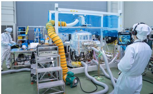
図 1: JAXA の筑波宇宙センターで衛星搭載前の単色 X 線によるキャリブレーション (Ti, Cu, Fe, Au-La, Cr, Au-Lb) を NASA メンバの遠隔試験のもと、実施中の写真。
